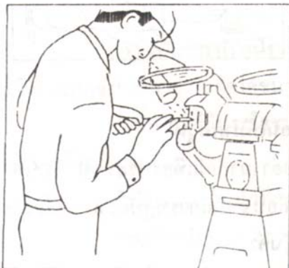
รูปที่ 4-18 อุปกรณ์ลมดูดติดตั้ง กับหินเจียรนัย
